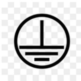
Caso não possua aterramento disponível em rede, deve ser implementado um aterramento exclusivo para a motobomba a fim de mitigar a possibilidade de danos ao motor em caso de descargas elétricas e garantir a segurança no caso de fuga de corrente elétrica interna ao equipamento em caso de falha na isolação das bobinas do motor elétrico.
