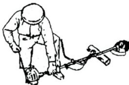
6. Assim que o motor entrar em funcionamento, retraia o afogador progressivamente até o equipamento permanecer em marcha lenta.
