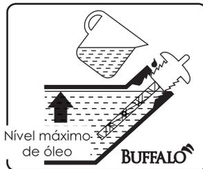
3 - Para os motores com potência de 7.5 cv, abastecer com 600 ml. Para os motores com potência de 9.0 cv e 16.0 cv, abastecer com 1100 ml.
