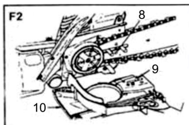
Fig. (F2) (8) Lingueta/furo do sabre. (9) Pino tensor. (10) Proteção da corrente.
