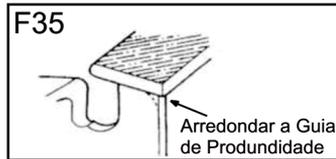
**Obs:** A regulagem da mordida do dente de corte na madeira se dá através da diferença entre a altura do canto superior do dente de corte e a guia de profundidade. Esta medida deve ser de .25" (6.35mm). Se forem efetuadas algumas afiações no dente e não acompanhar na guia, o corte da madeira será comprometido.
